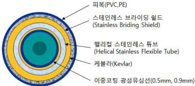
(그림 5-7) 스틸튜브형 구조 (이중 코팅 광심선, IB 광심선 수용)
