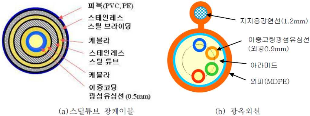
(그림 II-1-9) 스틸튜브 광케이블 및 광속외선의 구조
